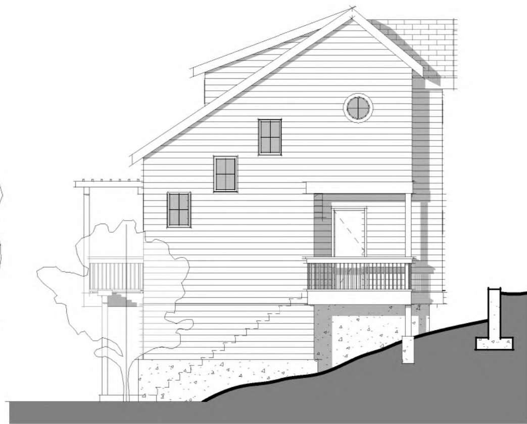
⑥ UNIT D1 RIGHT ELEVATION 1/8" = 1'-0"
